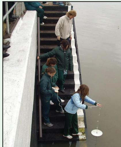
Determinación de transparencia con disco de Secchi
